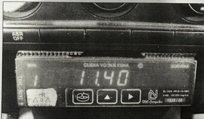
Slika 5. Primjer postavljene zaštitne oznake na taksimetru
